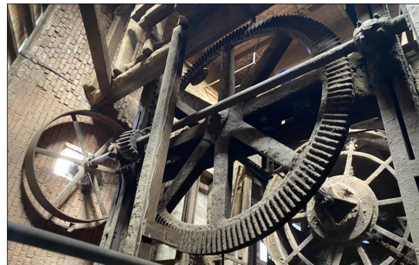
Das alte Mahlwerk für den Lehm ist noch vorhanden. Foto: Hansi Denterlein
